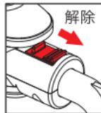
開閉ロックを解除するときは、プレートを閉じた状態で持ち、解除後にプレートを開いてください。
