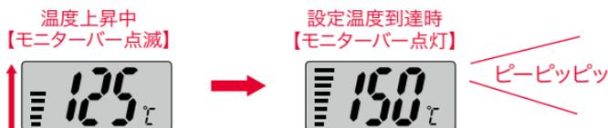
(設定温度より低い温度に変更したときは、モニターバーが下向きスクロール・点滅します。設定温度になるとモニターバーが点滅から点灯に変わります。)
