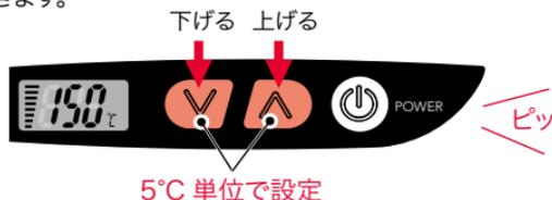
※温度設定を大幅に変更されるときは、温度調節ボタンを長押ししてご希望の温度に変更してください。60°C～210°Cまで設定できます。
