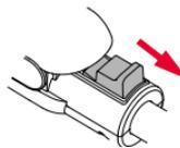
ロックを解除するときは、プレートを閉じた状態で持ち、解除後にプレートを開けてください。
